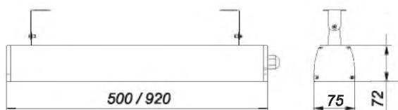
Светильники мощностью 150, 200, 300 и 400 Вт получаются за счет группировки и сбора нескольких светильников 50 или 100 Вт в единую конструкцию
